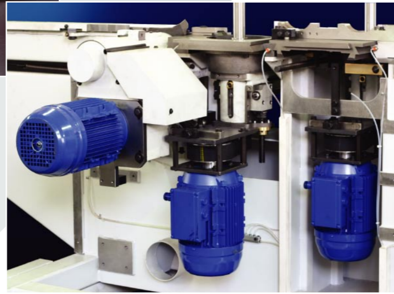
Il traino a scatole ingranaggi con giunti cardanici, da una grande garanzia di durata nel tempo senza manutenzione e con traino sempre costante.
