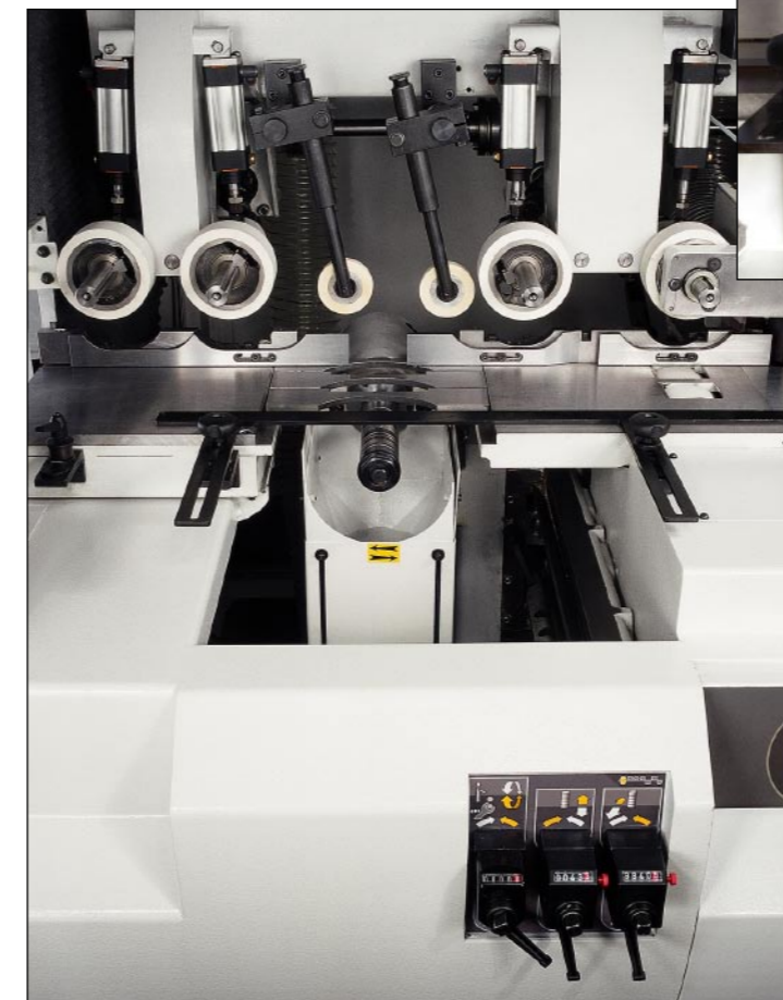
L'albero universale può essere utilizzato nelle 4 posizioni di lavoro. Sullo stesso è possibile alloggiare fresse con diametro minimo di 110 mm e massimo di 180 mm e a richiesta sono eseguibili particolari esecuzioni con l'uso di lame con Ø massimo di 250 mm.
