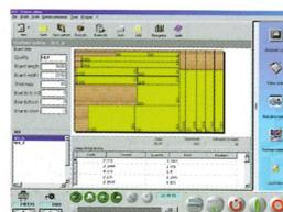
Der G57 Schnittplaneditor ermöglicht die Eingabe von neuen Schnittpläne während die Maschine produziert sowie die Anzeige der Schnittplangrafik mit der Darstellung von Resten und Fixmassen.
