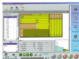
Die Durchführung des Schnittzyklus wird auf dem Monitor gleichzeitig zu den Maschinenabläufen dargestellt. Dadurch führt die G57-Steuerung den Bediener grafisch in Echtzeit durch die Schnittsequenzen.
