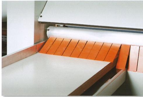
**Die Druckbalkenabdeckung und die vorderen Schutzlamellen** (Jede Schutzlamelle bewegt sich unabhängig) garantieren maximale Sicherheit und optimale Absaugung.
