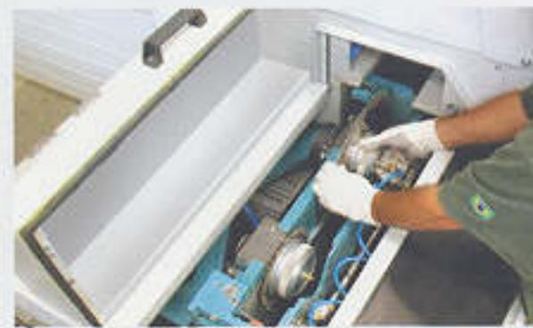
**Carro lame** ampiamente dimensionato garantisce la massima stabilità e precisione durante la sezionatura del pannello. **Equipaggiato di gruppo pneumatico** per lo smontaggio rapido degli utensili.
