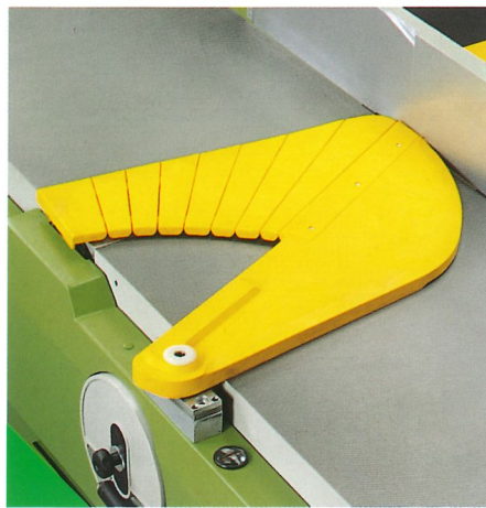
Protezione albero "Fried". "Fried" shaft protection. "Fried" Schutz. Proteccion arbre "Fried". Proteccion eje "Fried".
