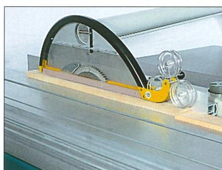
Dispositivo di sollevamento automatico del parallelogramma
