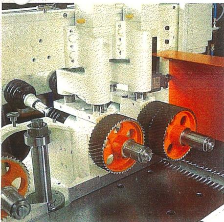
Minimierung der Schärfkosten: Durch die Arbeitsbreiten und -höhen von 230/140 mm werden, durch gegenseitiges Auswechseln der horizontalen und vertikalen Hobelköpfe, die Messer in voller Länge genutzt.
