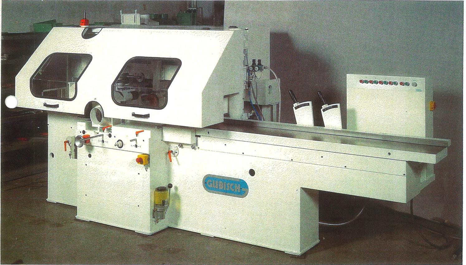
Mit 4 oder 5 Spindeln, fünfte Spindel als Universalspindel 180 Grad schwenkbar
