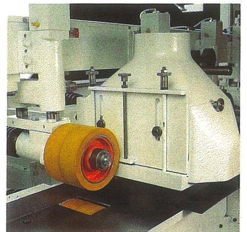
Perfekter Vorschub auch bei extremen Werkstücken: Durch Vollkardan, pneum. Walzendruck und Aushub der Vorschubwalzen in Kugelführungsbuchsen, verbunden mit der synchron laufenden, pneum. gedrückten Auszugswalze im Auslauftisch.
