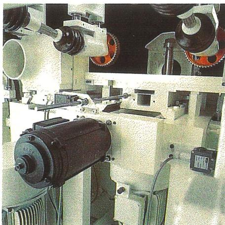
Schnellverstellungspaket: Durch elektrische Positionierung wird in Sekundenschnelle auf andere Arbeitshöhen und -breiten umgerüstet.
