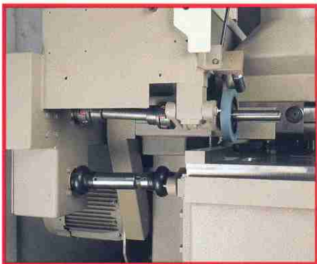
2 - Extraction des bois par système DUOMATIC motorisé dessus-dessous "cardan homocinétique".
