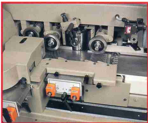
3 - Compteurs numériques mécaniques sur le déplacement des toupies droite et gauche.
