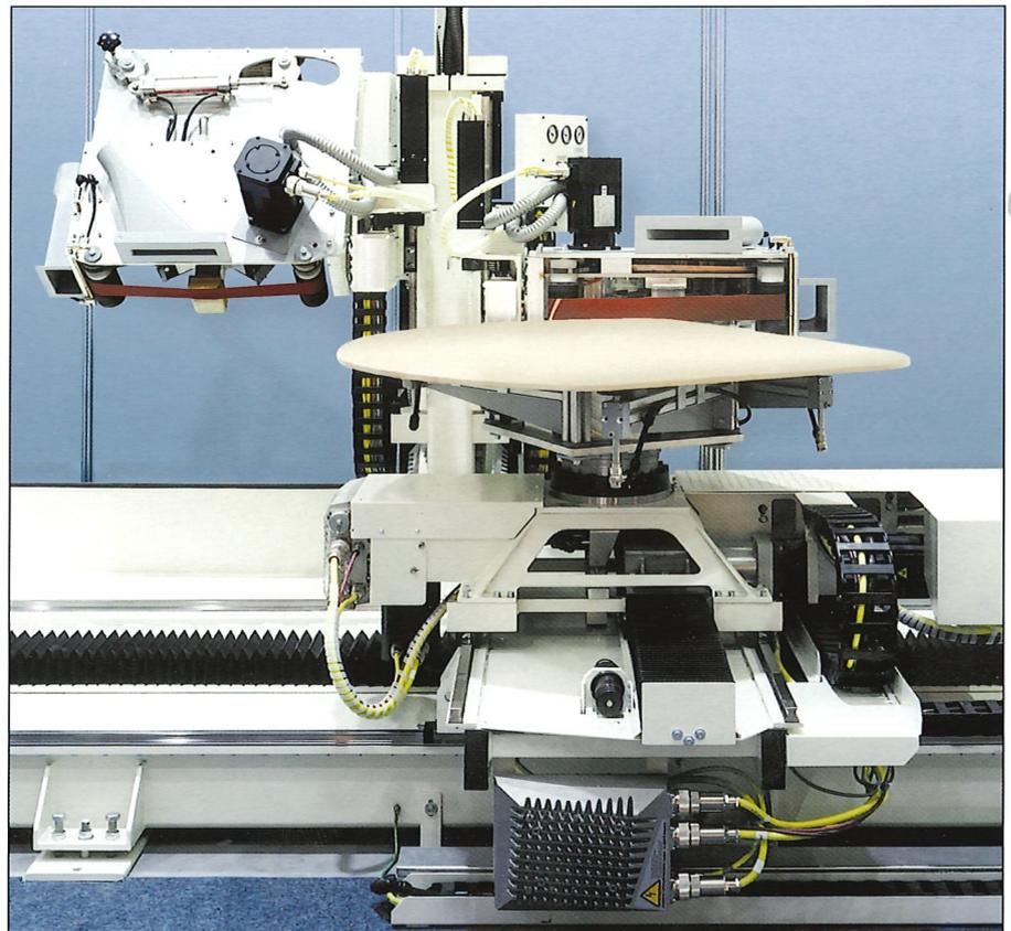
Die Steuerung des Schleif-Bearbeitungszentrums basiert auf einem neuartigen Steuerungskonzept mit dezentralen Antrieben. Die numerische Steuerung erfolgt direkt aus dem PC. Die Programmierung der bahn-gesteuerten Achsen wird entweder über einen externen Programmierplatz oder den PC an der Maschine vorgenommen. Damit steht der Weg einer werkstatorientierten
