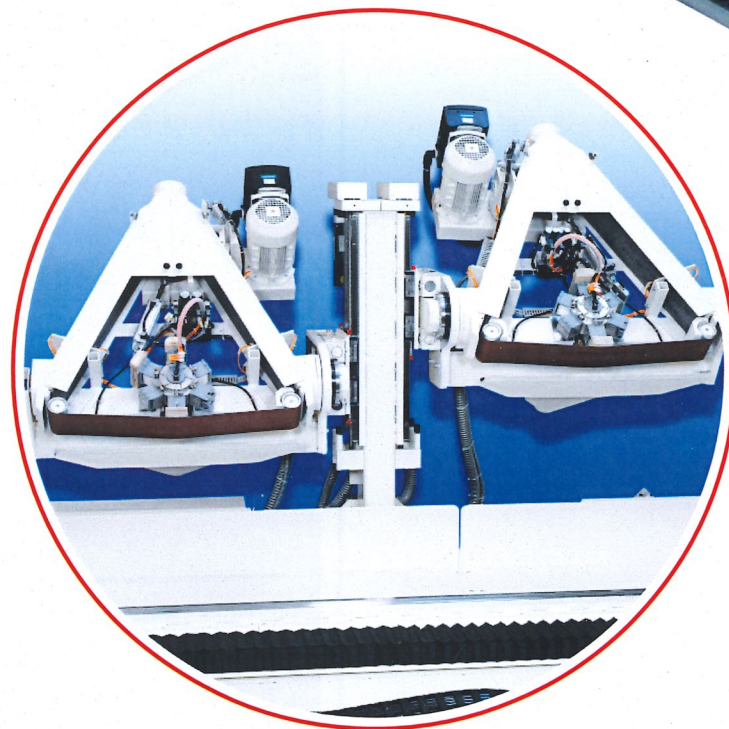
1 oder 2 Schleifaggregate, CNC gesteuert
