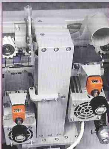
**Gruppo refilatore** con scorrimento su barre temperate rettificata di grossa dimensione con copia circolare verticale sulle facciate superiore ed inferiore del pannello, con copia frontale a pattino per eseguire un'ottima finitura della refilatura del bordo ABS. Motori con albero porta fresa con gioco assiale zero per una finitura ottimale con tutti i tipi di bordo.
