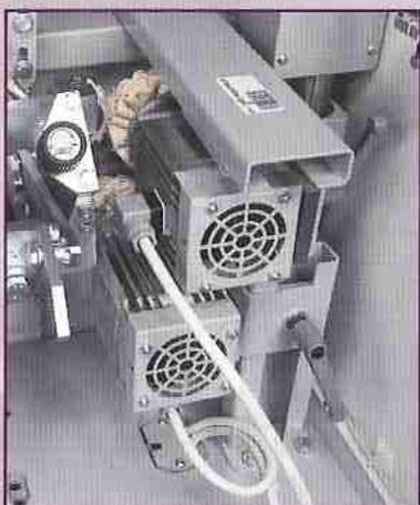
**Gruppo spazzole** inclinabili con regolazione verticale automatica smontabile rapidamente per sostituire l'utensile.
