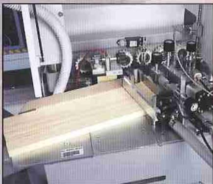
**Caricastrisce** - Dispositivo per l'avanzamento motorizzato del bordo in rotolo o stecche. Il cambio di lavorazione da un tipo all'altro avviene tramite l'azionamento di una leva che elimina la cesoia del bordo e inserisce automaticamente il regolatore di altezza delle stecche.
