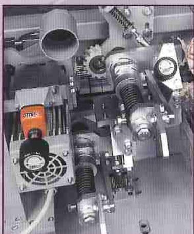
**Gruppo raschiabordo** di facile e rapido inserimento / disinserimento con dispositivo di espulsione truciolo. Struttura rigida per una finitura continua del profilo raggiato con regolazione su assi X e Y. Umidificatore del bordo e della facciata superiore del pannello, con sciogli colla che con l'intervento delle spazzole pulisce e lucida il pannello, completando la lavorazione di finitura.
