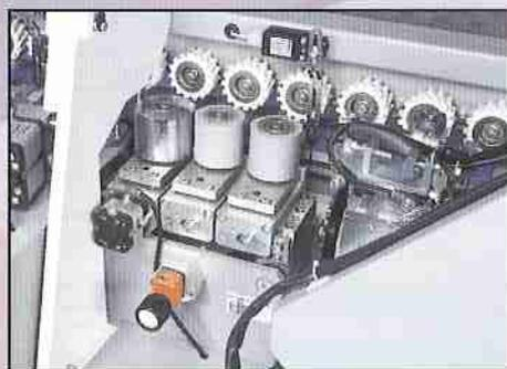
**Rulli di pressione indipendenti pneumatici** con regolazione graduale a seconda della flessibilità delle stecche in legno, possono essere regolati anche in senso verticale creando una conicità contrapposta. 1° rullo di pressione in acciaio per il raffreddamento immediato della colla. Rulli in gomma indipendenti per adeguamento alle deformità del pannello.
