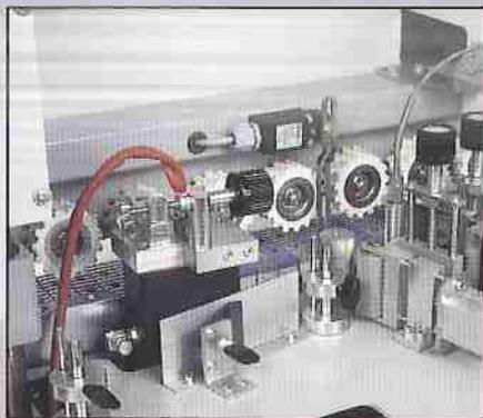
**Dispositivo a tempo di avanzamento bordo** motorizzato fino all'incontro con il pannello per un breve tratto successivo per garantire un buon incollaggio sulla prima parte del pannello dove si potrebbero avere slittamenti del bordo.
