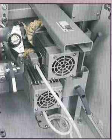
**Gruppo spazzole** inclinabili con regolazione verticale automatica smontabile rapidamente per sostituire l'utensile. Gruppo per la pulitura dei bordi in ABS e per riattivare il colore originale dopo la lavorazione.
