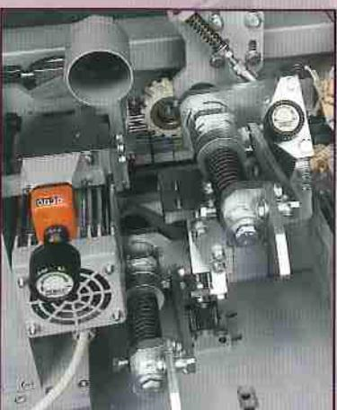
**Gruppo raschiabordo** di facile e rapido inserimento / disinserimento, con dispositivo di espulsione del trucciolato (opt). Struttura rigida per una finitura continua del profilo raggiato con regolazione su assi X e Y, elimina le eventuali onde di raggio create dalle frese del gruppo refilatore.
