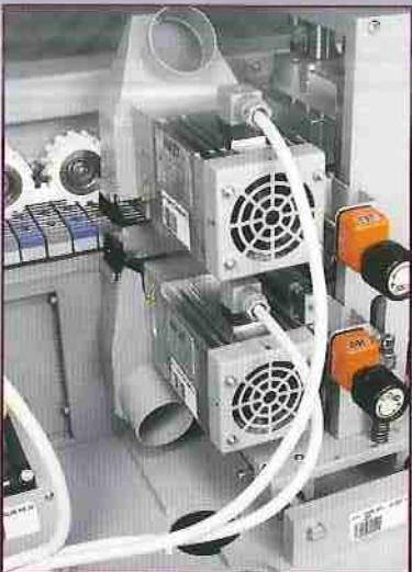
**Gruppo refilatore** con scorrimento su barre temperate rettificate di grossa dimensione, con copia verticale sulle facciate superiore ed inferiore del pannello, con copia frontale a pattino per eseguire un' ottima finitura della refilatura del bordo ABS. Motori con albero porta fresa con gioco assiale zero per una ottima finitura di tutti i tipi di bordo.
