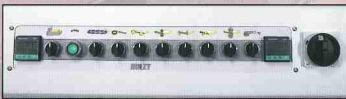
**Quadro comandi** con selettori di tutte le funzioni con visualizzatore digitale della temperatura della colla e dell'aria calda che viene regolata a seconda del tipo di colla .
