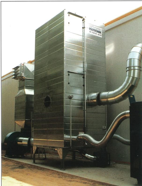
Unterdruck-Zwischensilo-Filter mit Hochleistungsventilator und Containerbeschickung
