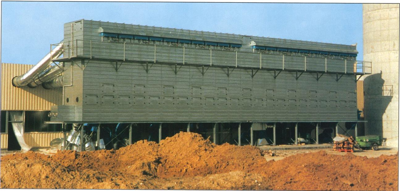
Unterdruck-Filteranlage für kontinuierlichen Betrieb, 2.240 m<sup>2</sup> Filterfläche
