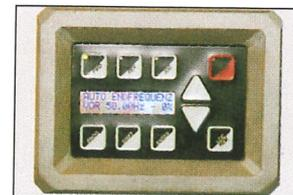
Bedientableau für Drehzahlregelung
