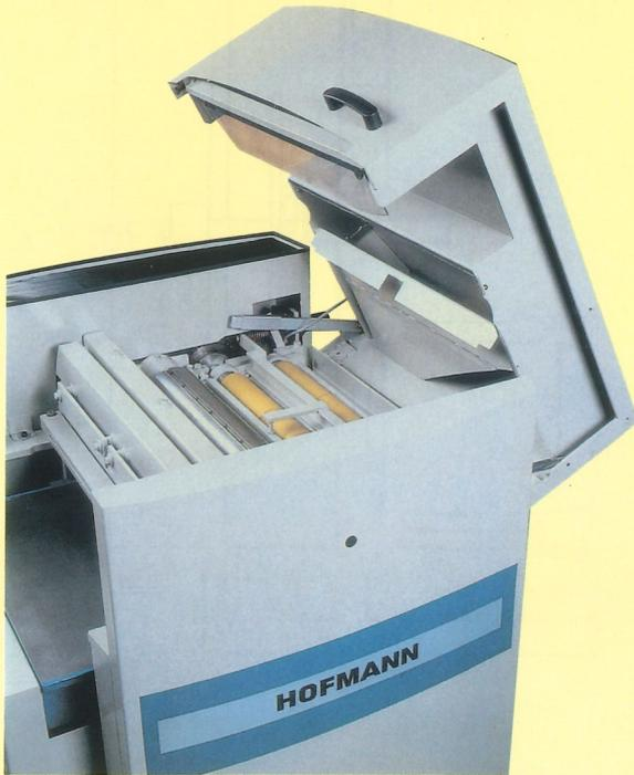
Die Haube ist durch die Unterstützung mit einer Gasfeder leichtgängig hochschwenkbar. Messerwelle, Vorschubwalzen und Druckbalken sind bequem zu erreichen. Die Absaugung ist in der Haube integriert, der Anschlußstutzen mit 160 mm  $\varnothing$  geht seitlich ab. Die großzügige Werkzeugablage und die mit Teppich belegte Haube, zur kratzfreien Ablage von Werkstücken, runden den Ausstattungskomfort ab.
