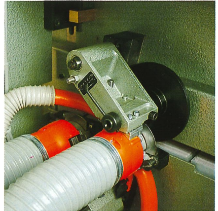
Kantenzuführung automatisch Kantenlänge min. 350 mm Kantenhöhe max. 51 mm Kantendicke einzeln 0,3 – 25 mm für Rollenware 0,3 – 0,8 mm Rollendurchmesser max. 500 mm
