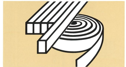
Kantenzuführung automatisch Kantenlänge min. 350 mm Kantenhöhe max. 51 mm Kantendicke einzeln 0,3 – 25 mm für Rollenware 0,3 – 0,8 mm Rollendurchmesser max. 500 mm
