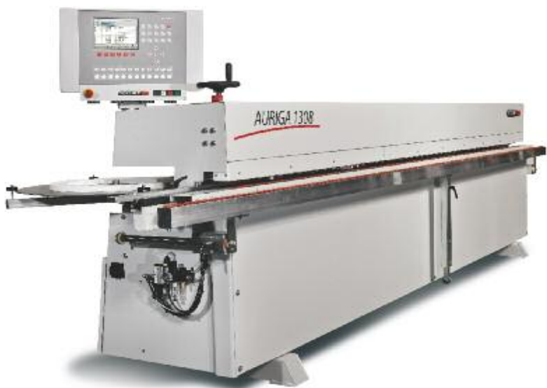
Ausziehbare Werkstückauflage bis 600 mm (1). Werkstückdicke bis 60 mm (2).
