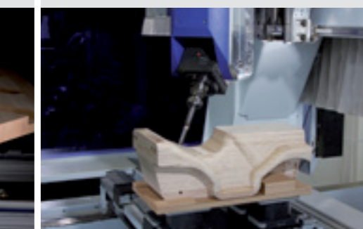
Интерполированная обработка фигурных деталей
