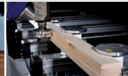
Профильная обработка деталей рам
