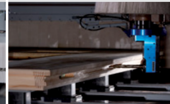
Фрезерование гнезд под замки в наружных дверях
