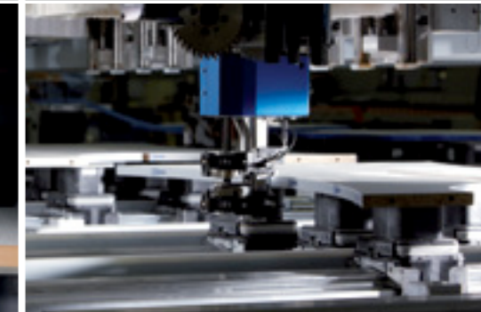
Качественная обработка кромки благодаря ощупывающему комбинированному агрегату для чистового фрезерования и зачистки
