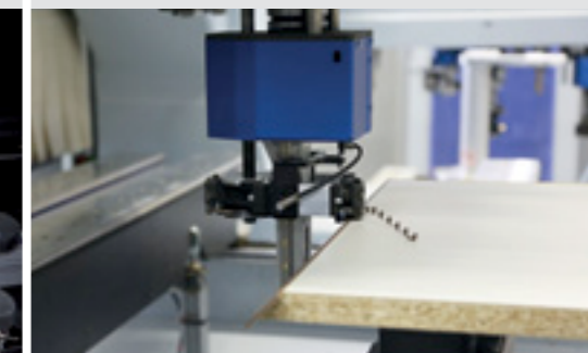
Обработка с помощью циклевальных агрегатов на скошенной кромке
