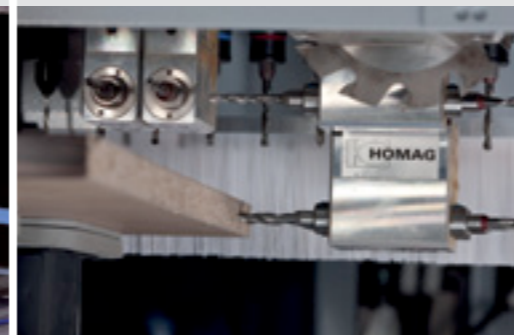
Горизонтальные сверления для корпусных соединений
