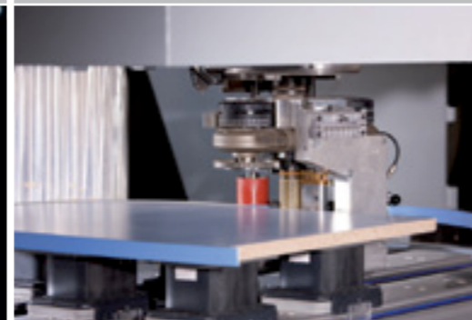
Gruppo di incollaggio easyEdge per l'incollaggio dei bordi su pezzi sagomati
