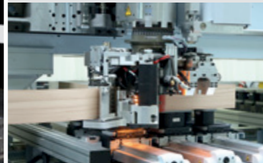
Bordatura per pezzi con un'altezza fino a 100mm
