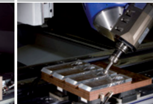
Fresatura di pezzi acrilici brillanti
