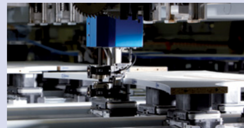
Una finitura perfetta dei bordi grazie al gruppo combinato di reflitura/raschiatura con tastatura – due lavorazioni con un unico gruppo!
