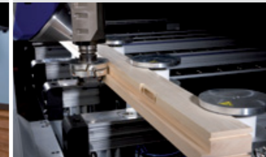
Profilatura di telai
