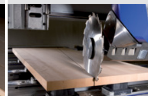
Tagli fino ad una altezza di 110 mm
