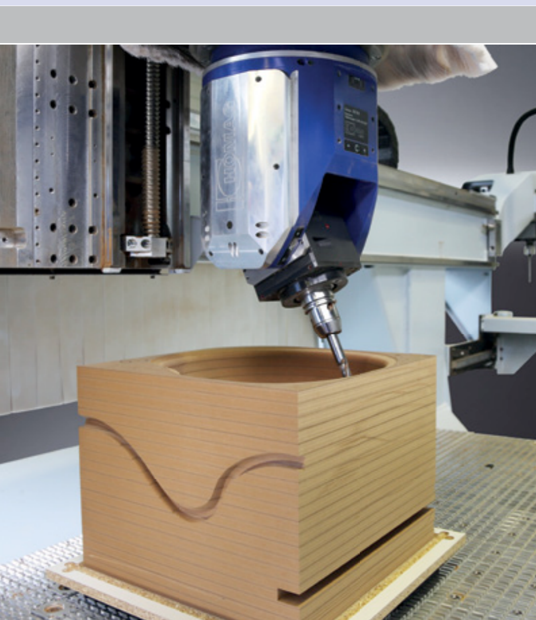
Fresatura di pezzi molto alti in Z
