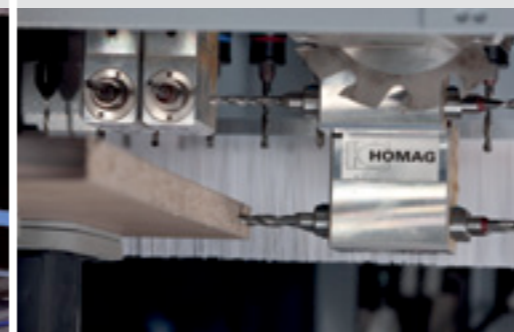
Forature orizzontali per giunzioni di mobili
