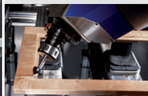
Fresatura ad angolo retto su uno spigolo per la battuta del vetro
