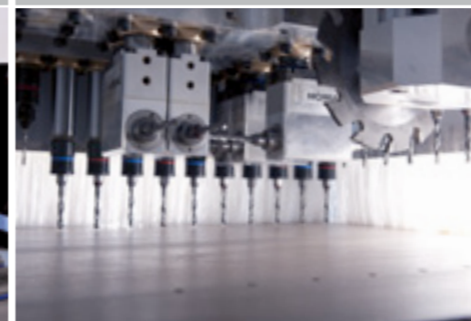
Técnica de furação em alta velocidade com serra de ranhuras
