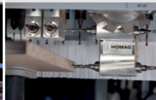
Furação horizontal para encaixes de peças
