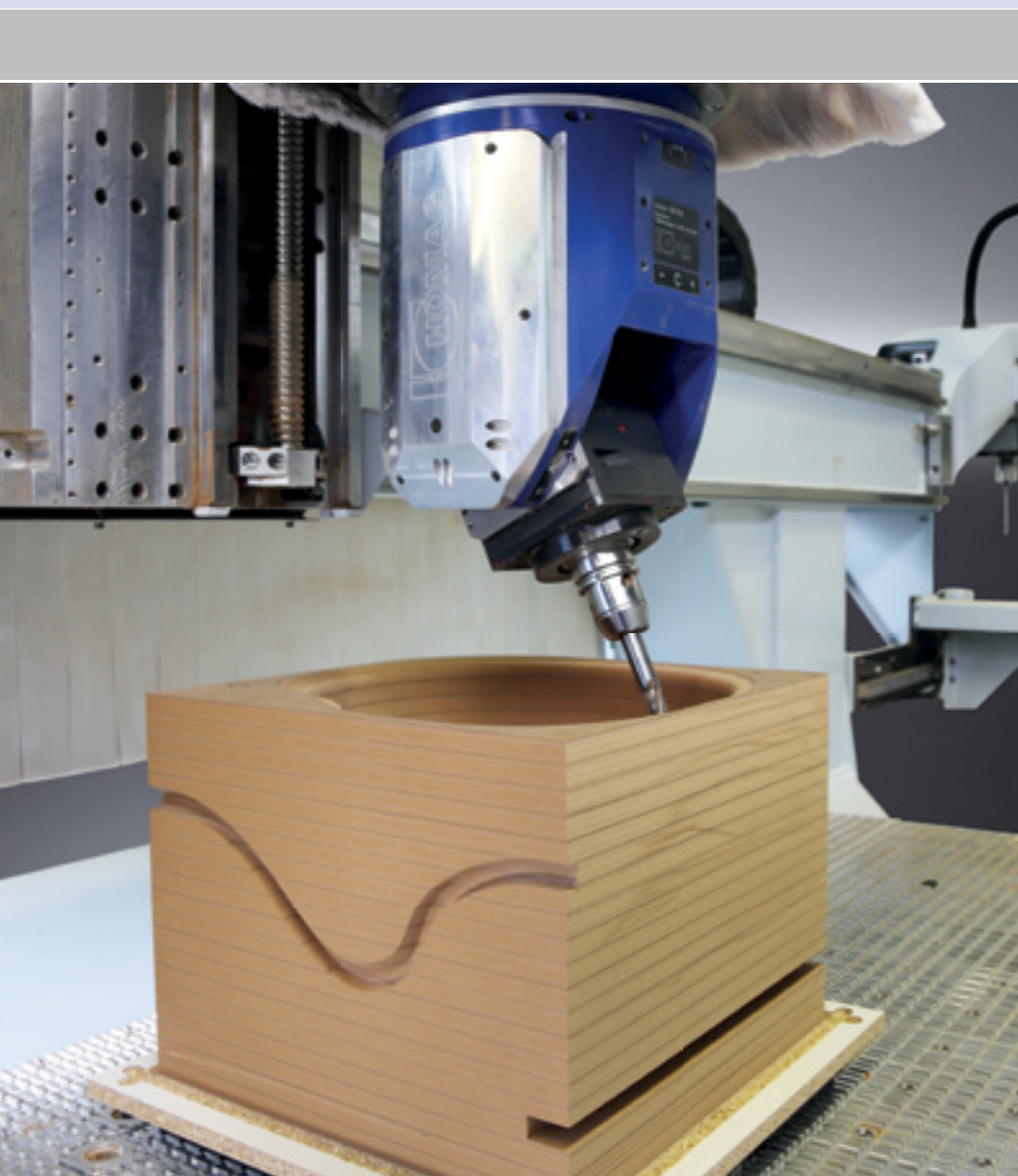
Fresagem de componentes de altura ampla
