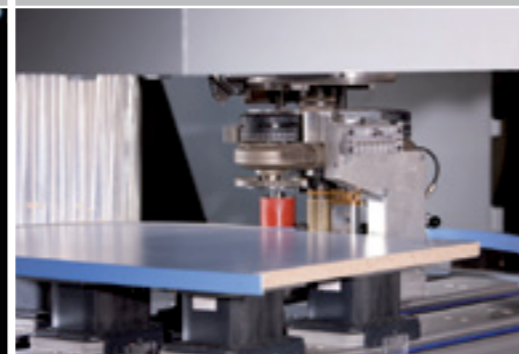
Grupo colador easyEdge Para a colagem eficiente para molduras
