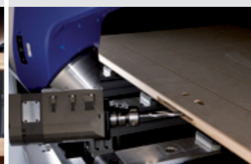
Fresagem para encaixe de fechaduras
