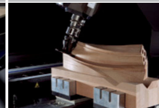
Usinagem de corrimãos de escadas
