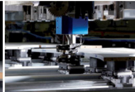
Качественная обработка кромки благодаря ощупывающему комбинированному агрегату для чистового фрезерования и зачистки
