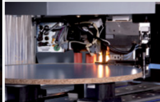
360° облицовка кромки с помощью кромкооблицовочного агрегата powerEdge
