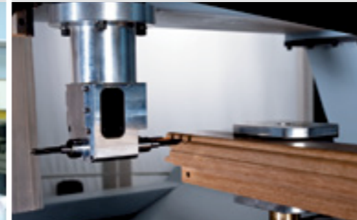
Точное пазование угловых соединительных отверстий под шканты
