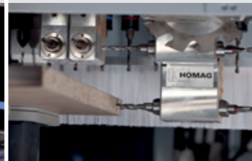
Горизонтальные сверления для корпусных соединений
