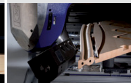
Сверления под балясины под острым углом
