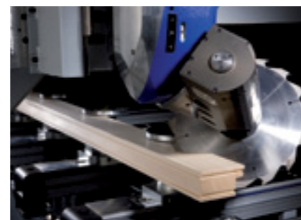
Точная косая врубка даже при большой толщине материала
