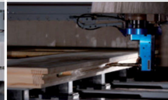
Фрезерование гнезд под замки в наружных дверях
