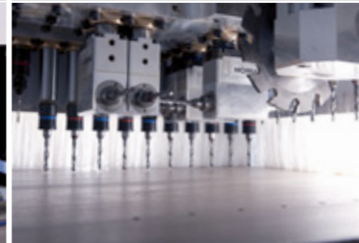
Высокоскоростная сверлильная техника с пилой для выборки пазов
