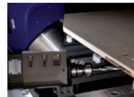
5-ти осевой шпиндельный агрегат DRIVE5C+ для универсального использования
