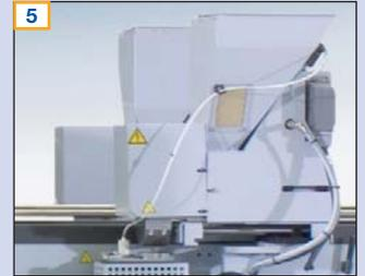
**Aufschmelzeinheit mit Granulatbehälter**
