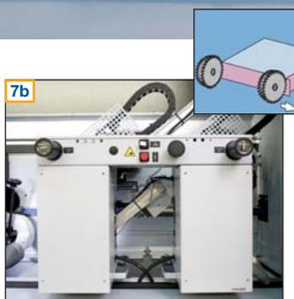
**Agrégat de coupe en bout HL81** pour la coupe en bout des dépassements de chants sur le chant avant et arrière (compris dans la KAL 520/A12).
