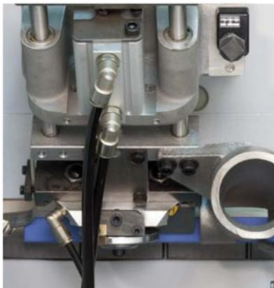
Réglage automatique de l'affleurage/coupe en bout avec dépassement pour un changement rapide entre l'affleurage d'alèses en bois massif ou de fonds incrustés et la coupe en bout avec dépassement (pour le fraisage par l'agrégat de fraisage de forme)
