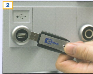
USB-Schnittstelle zur Dateneingabe oder Datensicherung auf externe Speicher. Damit können sämtliche Daten aus der Maschinensteuerung heruntergeladen und gesichert werden. Nach einer Unterbrechung ist das System durch die 1:1 Datensicherung sofort wieder betriebsbereit.
