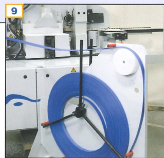
Magazin mit 2 Rollen ermöglicht einen schnellen, problemlosen Wechsel des Kantenmaterials und spart damit Zeit.
