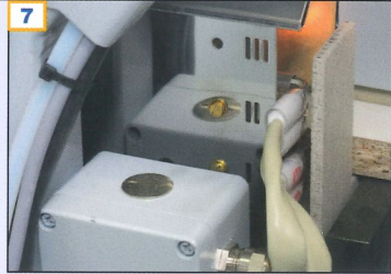
Werkstückvorwärmung zur Temperierung der Werkstücke vor dem Verleimen.
