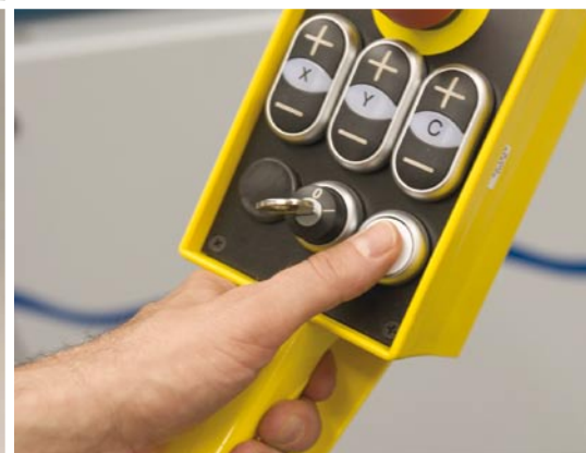
Fernbedienung für einseitige Maschine ermöglicht das schnelle Einrichten
