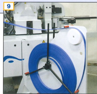
9 Magazin mit 2 Rollen ermöglicht einen schnellen, problemlosen Wechsel des Kantenmaterials und spart damit Zeit.
