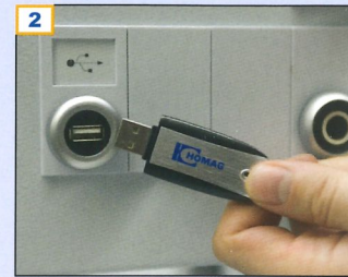
2 USB-Schnittstelle zur Dateneingabe oder Datensicherung auf externe Speicher. Damit können sämtliche Daten aus der Maschinensteuerung heruntergeladen und gesichert werden. Nach einer Unterbrechung ist das System durch die 1:1 Datensicherung sofort wieder betriebsbereit.
