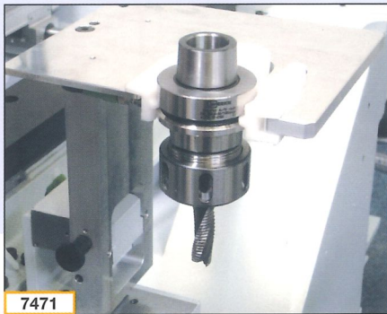
7471 Werkzeugübergabeplatz, sicheres und schnelles Beschicken des Werkzeugwechslers inkl. Leerplatzabfrage im Werkzeugwechsler
