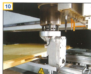
10 Interpolierende C-Achse 360°: um die Aggregate in beliebigem Winkel drehen zu können, inkl. Druckluftübertragung in die Aggregate (z.B. zum Abblasen von Spanresten)
