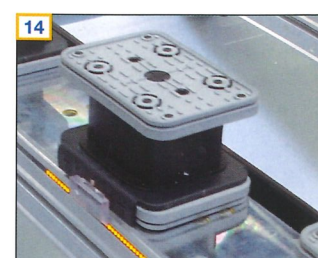
14 Leuchtdiodenkettens (LED) zur einfachen und schnellen Positionierung der Vakuumpspanner und Konsolen
