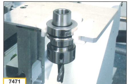
Werkzeugübergabeplatz, sicheres und schnelles Beschicken des Werkzeugwechslers inkl. Leerplatzabfrage im Werkzeugwechslers
