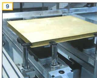
9 Anschlagbolzen mit klappbaren Anschlagplatten für beschichtete Werkstücke mit Deckschichtüberstand
