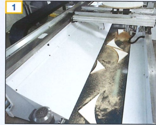
1 Arbeitsfeld von X = 4.175 mm (10L) bzw. 6.175 mm (10XL) und Y = 1.730 mm mit optimaler Reststückentsorgung durch das „offene“ Maschinenbett (optional mit Spänetransportband)
