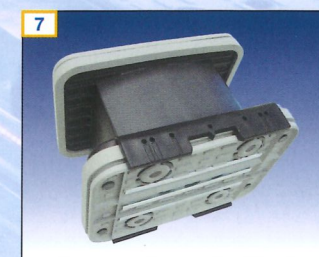
7 Vakuumsauger mit speziellem Kammerensystem (Patent der HOMAG Gruppe) zur freien Positionierung auf den Konsolen (16/20 Standard- und 8/10 Schmalteilesauger)
