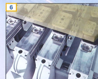
6 Arbeitstisch mit 8 bzw. 10 Konsolen und präzisen Linearführungen zur optimalen Werkstückspannung bei schwerer Zerspansung
