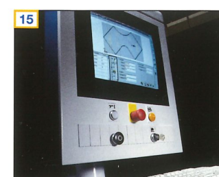
15 power control Steuerung PC 85: mit schwenkbarem Bedienpult für die einfache Maschinenbedienung durch Features wie Graphische Werkzeugdatenbank und Maschinendatenerfassung (MDE)
