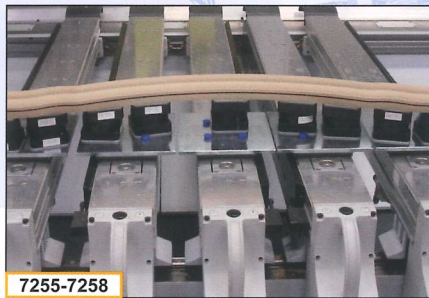
Maxi-Flex-Spannsystem für die flexible Aufspannung von Formteilen
