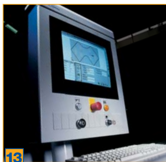
13 commande power control PC85 : avec pupitre de commande pivotant pour une conduite simple de la machine grâce à une banque de données d'outils graphique et la gestion des données machine (MDE)
