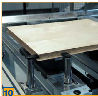
10 Butées avec taquets rabattables pour les pièces au revêtement dépassant
