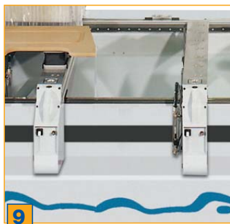
9 Consoles avec circuits de dépression et d'air comprimé pour une accessibilité optimale
