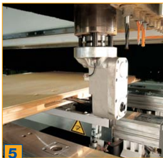
5 Axe C 360° à interpolation : pour une rotation des agrégats quelque soit l'angle, avec transmission de l'air comprimé dans les agrégats (pour alimenter une soufflette et évacuer les copeaux par ex.)
