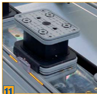
11 Diodes électroluminescentes (DEL) pour un positionnement simple et rapide des ventouses et des consoles
