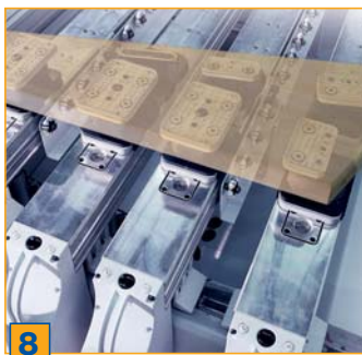
8 Table de travail à 8 consoles et guides linéaires précis pour un serrage de pièce optimal pour les opérations de défonçage à haut débit
