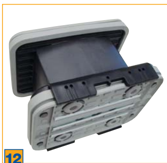
12 Ventouse avec circuit confiné (brevet Homag) pour le positionnement libre sur les consoles (16 ventouses standards et 8 ventouses pour pièces étroites)
