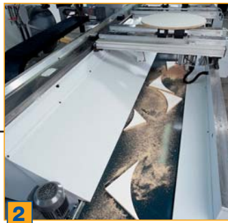
2 Zone de travail de X=4175 mm (10) ou 6175 mm (11) et Y=1730 mm (en option 2075 mm avec broche supplémentaire) avec évacuation des chutes par le bâti lisse de la machine (en option: tapis de transport)
