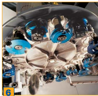
6 Cambiador de cadena de alta velocidad, con 18 puestos de grandes dimensiones, para herramientas y unidades con diámetros de hasta 180 mm
