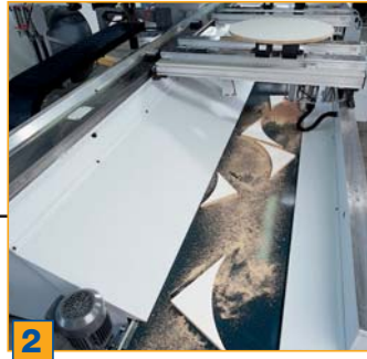
2 Superficie de tableros de X=4.175 mm (10) ó 6.175 mm (11) por Y=1.730 mm (opcionalmente 2.075 mm con husillo secundario), provista de sistema de evacuación de retales sobre la banca lisa de la máquina (opcionalmente con cinta transportadora para virutas)
