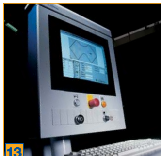
13 Control power control PC 85: con pupitre de manejo basculable, para un manejo sencillo de la máquina mediante funciones como la base de datos gráfica de herramientas y la captura de datos de máquina
