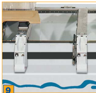
9 Consolas con tubos de entrada de vacío y aire comprimido ocultos, para una accesibilidad óptima
