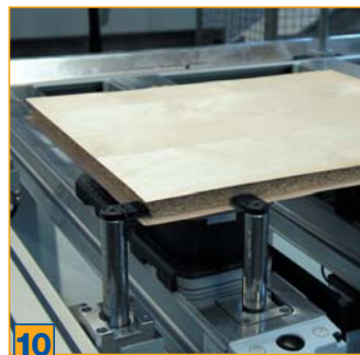
10 Pivotes de tope con placas de tope abatibles, para tableros rechapados en los que sobresale el recubrimiento
