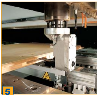
5 Eje C con interpolación sobre 360°: para poder girar las unidades en cualquier ángulo, con transferencia de aire comprimido hasta las unidades (p.ej. para expulsar restos de virutas)
