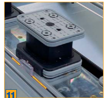
11 Cadenas de diodos luminosos (LED), para un posicionamiento sencillo y rápido de los elementos de fijación mediante ventosa y las consolas
