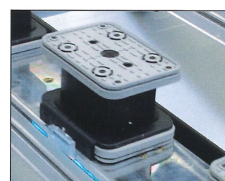
Leuchtdiodenanzeigen (LED) zur einfachen und schnellen Positionierung der Vakuumspanner und Konsolen
