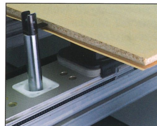
Anschlagbolzen mit klappbaren Anschlagplatten für beschichtete Werkstücke mit Deckschichtüberstand. Mit Endlageüberwachung der Anschlagbolzen zum Schutz vor Beschädigungen von Werkzeugen und Aggregaten
