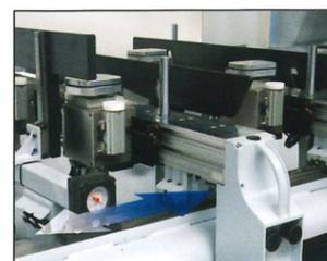
Automatische Konsolenpositionierung für ein schnelles, sicheres Einrüsten. Robuste Einlegehilfen zur Auflage schwerer Werkstücke
