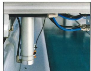
Anschlagbolzen mit Endlageüberwachung zum Schutz vor Beschädigungen von Werkzeugen und Aggregaten
