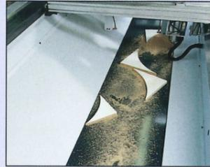
Hochsteifes Maschinenbett mit integrierter Reststückfassung über die gesamte Bearbeitungstiefe von 1.300 mm. Es fallen keine Reststücke vor die Maschine (optional mit Spänetransportband)
