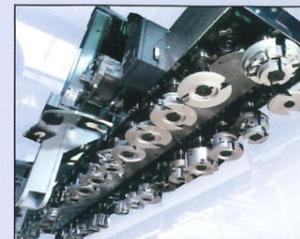
Schneller Kettenwechsler mit 30 großen Plätzen für Werkzeuge und Aggregate mit einem Durchmesser von bis zu 180 mm. Für Schlitz-/ Zapfenverbindung können auch größere Werkzeugdurchmesser eingesetzt werden
