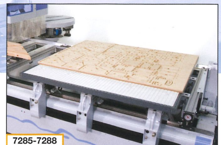
Matrix-Adapterplatte – für Nesting-Anwendungen und zum Spannen von Kleinteilen mit individueller Formgebung
