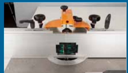
Abb. zeigt Sicherheits-Systemanschlagbacken angebaut an der Tischfräse
