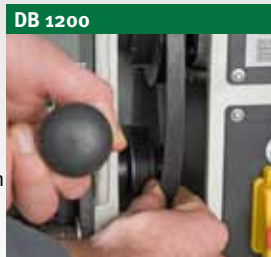
Werkzeugloses Wechseln der Übersetzungsstufe durch leichtes Ummontieren des Keilriemens
