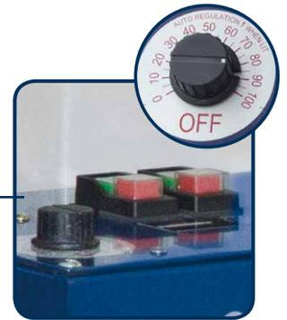
Stufenlos einstellbare variable Vorschubgeschwindigkeit von 0 - 6 m/min
