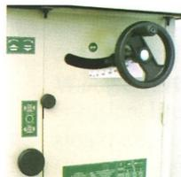
Ideale Fräs- Drehzahlabstimmung von 1400 min. bis 8000 min. Dadurch kann die Fräsmaschine auch für Schleifarbeiten herangezogen werden. Einfachste Spindelblockierung durch Drehen der Blockierungsschraube bis zum Einrasten. Exakte Frässpindelverstellung mit genauer Anzeige
