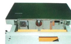
Das stabile **Doppelwiegensägeaggregat aus Grauguß** ist beidseitig breit gelagert. Es gewährt höchste Stabilität, Präzision, hohe Laufruhe und lange Lebensdauer. Die Maschine gibt es wahlweise mit separatem Vorritzmotor oder ohne Vorritzeinrichtung. (S 300 W)
