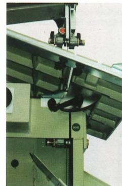
Sägetisch mit Schwenkeinrichtung aus Grauguß, schwenkbar bis 45° - stabil und präzise. Großdimensionierte und präzise Sägebandpräzisionsführung oben und unten serienmäßig.
