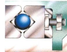
hochpräziser Formatschiebeschlitten aus fließgepresstem eloxiertem Aluminium mit bewährtem Kugelschlittensystem (Beschreibung S. 3)
