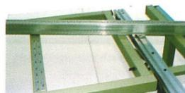
Durch den robusten Rahmen mit Teleskoplineal und einstellbaren Anschlägen können auch große und schwere Platten genau und problemlos geschnitten werden. Eine Rolle an einem Ende sorgt für die einfache und sichere Aufgabe des Werkstücks.
