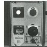
**Einfache Bedienung der Kombinationsmaschinen** durch Vorwählen der Funktionen sowie rechts oder Linkslauf (beim Fräsen)
