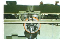
Stabil ausgelegter Kettenantrieb der Vorschubwellen mit Antriebsrädern aus Stahl, massiver Graugußlagerbock.
