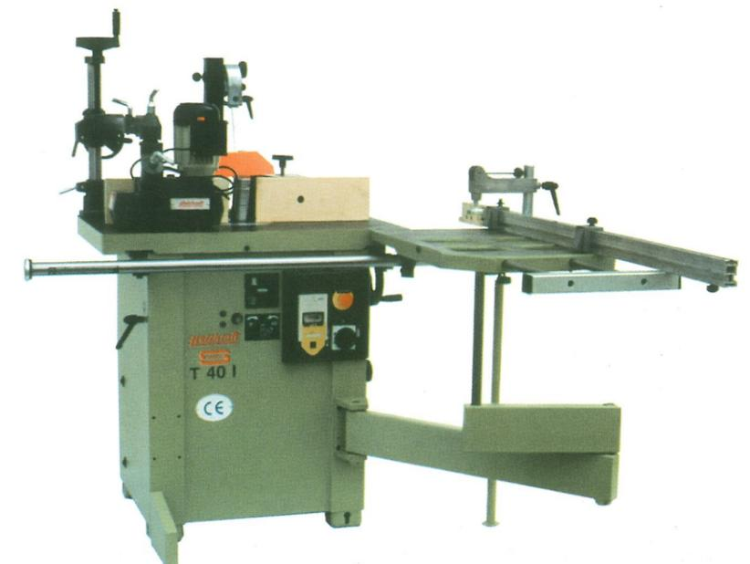
äußerst stabiler Schiebeschlitten mit Gußtisch, Schwenkarm, Teleskopverbreiterung und Teleskopanschlag
