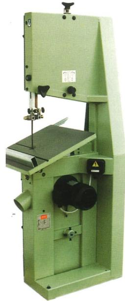
Die Hbs S 45 ist extrem stabil und absolut verwindungssteif konstruiert. Die integrierte Blattspannungsanzeige zeigt Ihnen die richtige Blattspannung für das jeweilige Sägeblatt an.
