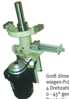
Groß dimensioniertes Doppelwiegen-Fräsaggregat mit 4 Drehzahlbereichen schwenkbar 0 - 45° gewährleistet bei jeder Bearbeitung optimale Fertigungsqualität und gestattet den Einsatz von geformten Schleifwerkzeugen.
