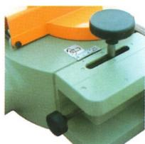
exakt dimensionierter Fräsanschlag mit Feineinstellung
