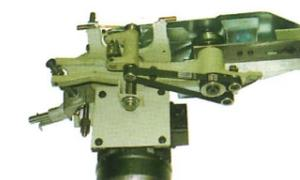
Groß dimensioniertes Doppelwiegen-Sägeaggregat aus Grauguß gewährleistet größte Stabilität und höchste Präzision, hohe Laufruhe sowie lange Lebensdauer. Schwenkbar bis 45°!
