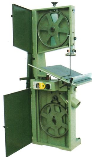
Stabile Zahnstange für präzise Höhenverstellung. Schwungradneigung und Bandspannung durch Schnellverstellung. Große, gewuchtete Gußschwungräder mit Gummibandagen - natürlich auch aus Garuguß, sorgen für gleichmäßigen und perfekten Rundlauf und hoher Laufruhe. Mit Absauganschluß.
