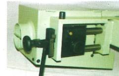
Die Bandenschnellspannung ermöglicht schnelles und problemloses Wechseln der Schleifbänder.
