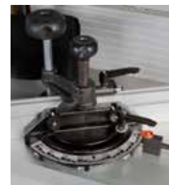
Stufenlos verstellbarer Winkelanschlag
