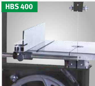
HBS 400 Sekundenschneller Umbau des Aluminium-Anschlags über Drehknopf für Arbeiten mit flachem Anschlag
