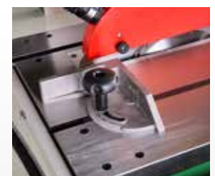
Sägeblattschwenkung von 90° bis -45° nach links
