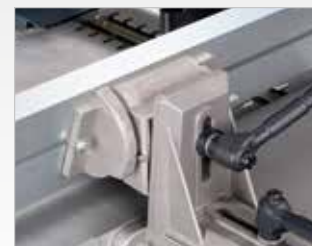
Der Aluminium-Abrichtanschlag ist um 45° neigbar. Die eingestellte Neigung ist bequem an einer Skala ablesbar.
