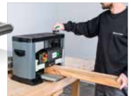
Höheneinstellung über Handkurbel und Skala
