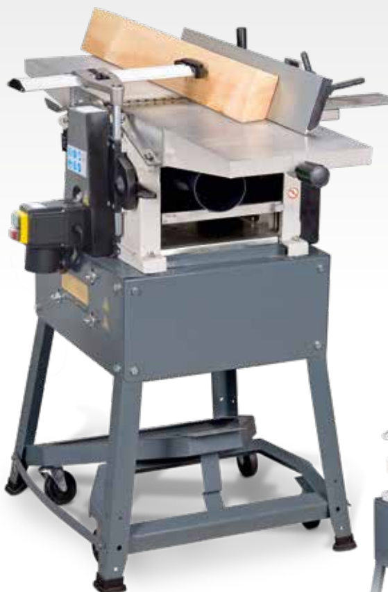
Der Aluminium-Abrichtanschlag ist um 45° neigbar. Die eingestellte Neigung ist bequem an einer Skala ablesbar.
