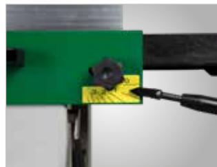
Verstellung der Spanabnahme über Bedienhebel
