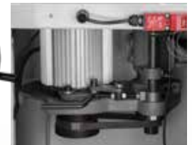
Schnelles und einfaches Wechseln der Drehzahl mittels Vielkeilriemen
