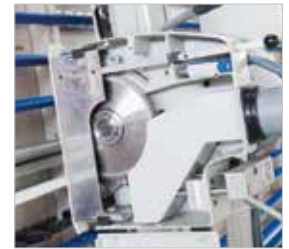
▶ Große Öffnung für Sägeblattwechsel
