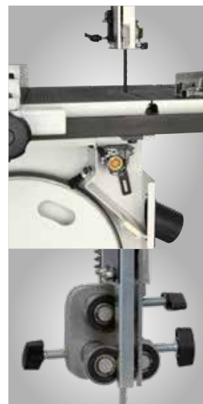
▶ Sägeband-Präzisionsführung oben und unten
