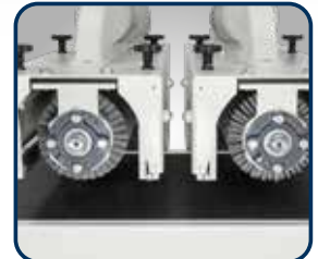
▶ Leicht auswechselbare Bürsten
