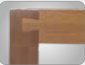
Schwalbenschwanzverzinkung in Hinterzange und Beiladerücken
