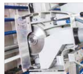
▶ Große Öffnung für Sägeblattwechsel
