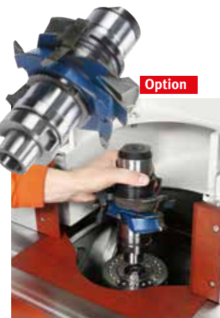
Auswechselbare Spindel, HSK
