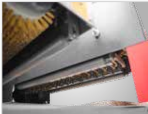
▶ Option: Einheit für Sägeschnittoptik
