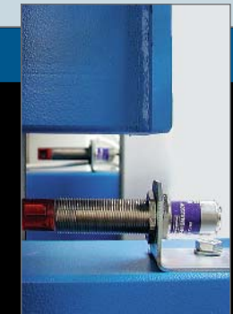
| S: ZENTRIERUNG DES SCHLEIFBANDES MIT INFRAROTSTRAHL
