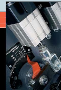
| S: KORREKTUR DER WERKSTÜCKHÖHE GEMÄSS DER SCHLEIFBANDKÖRNUNG
