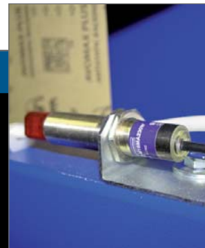
| S: ZENTRIERUNG DES SCHLEIF- BANDES MIT INFRAROTSTRAHL
