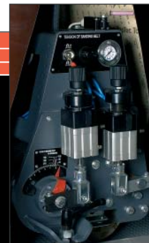
| S: SCHLEIFEINHEIT C – PNEUMATISCH EINSTELL- BARE ARBEITSWALZE
