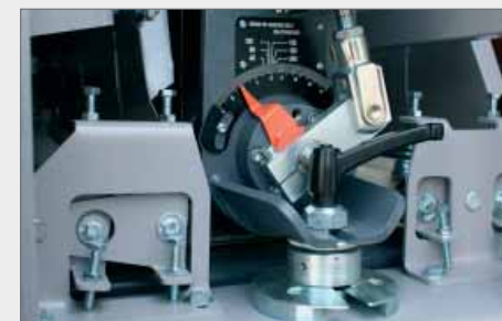
| MECHANICKÁ KOREKCE PRACOVNÍ VÝŠKY V ZÁVISLOSTI NA ZRNITOSTI BRUSNÉHO PÁSU
