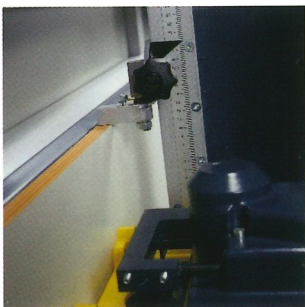
Strokenaanslag Voor herhaling van horizontale zaagsnedes.
