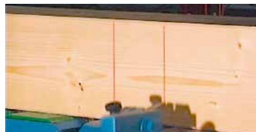
Pour un étiquetage et marquage simple des pièces usinées, la machine TURBO-Drive contient un système de marquage à encre et un marqueur ou une imprimante d'étiquettes. Il est donc possible de réaliser tous les marquages nécessaires, du marquage de chevron simple au texte à plusieurs lignes ou code-barres.
