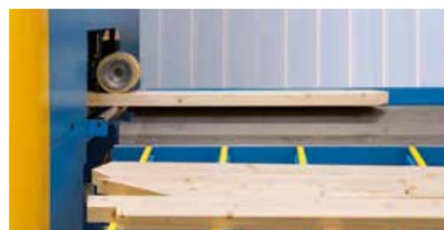
L'opérateur peut mettre plusieurs pièces de bois en même temps sur la chaîne d'alimentation latérale. Elles seront séparées automatiquement par la machine TURBO-Drive et puis transportées vers la zone d'usinage sans être endommagées. En même temps, l'opérateur peut se concentrer sur d'autres travaux. A la sortie de la machine il y a en plus un système de transport transversal pour les pièces usinées.
