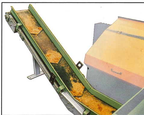
Spänebandförderer integriert im Maschinenbett, fördert Späne und Schnittreste aus der Maschine.
