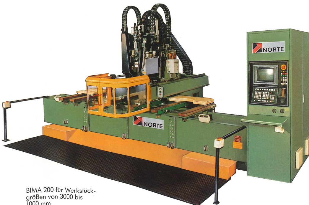
Frei positionierbare Werkstückträger mit Vakuum-Saugplatten
