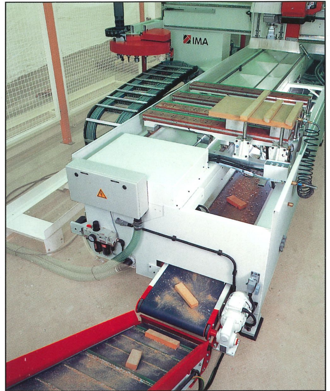
Die BIMA 610 kann optionell mit einem Spänetransportband ausgerüstet werden. Späne und Reststücke werden über das Transportband automatisch entsorgt und stören so weder die Beschickung noch den Bearbeitungsablauf.
