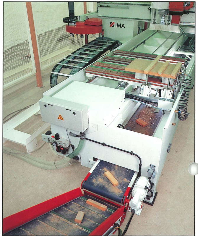
La BIMA 610 peut être équipée optionnellement d'une bande transporteuse à copeaux. Les copeaux et résiduels sont éliminés automatiquement par la bande transporteuse et ne dérangent ni l'alimentation ni le déroulement d'usage.
