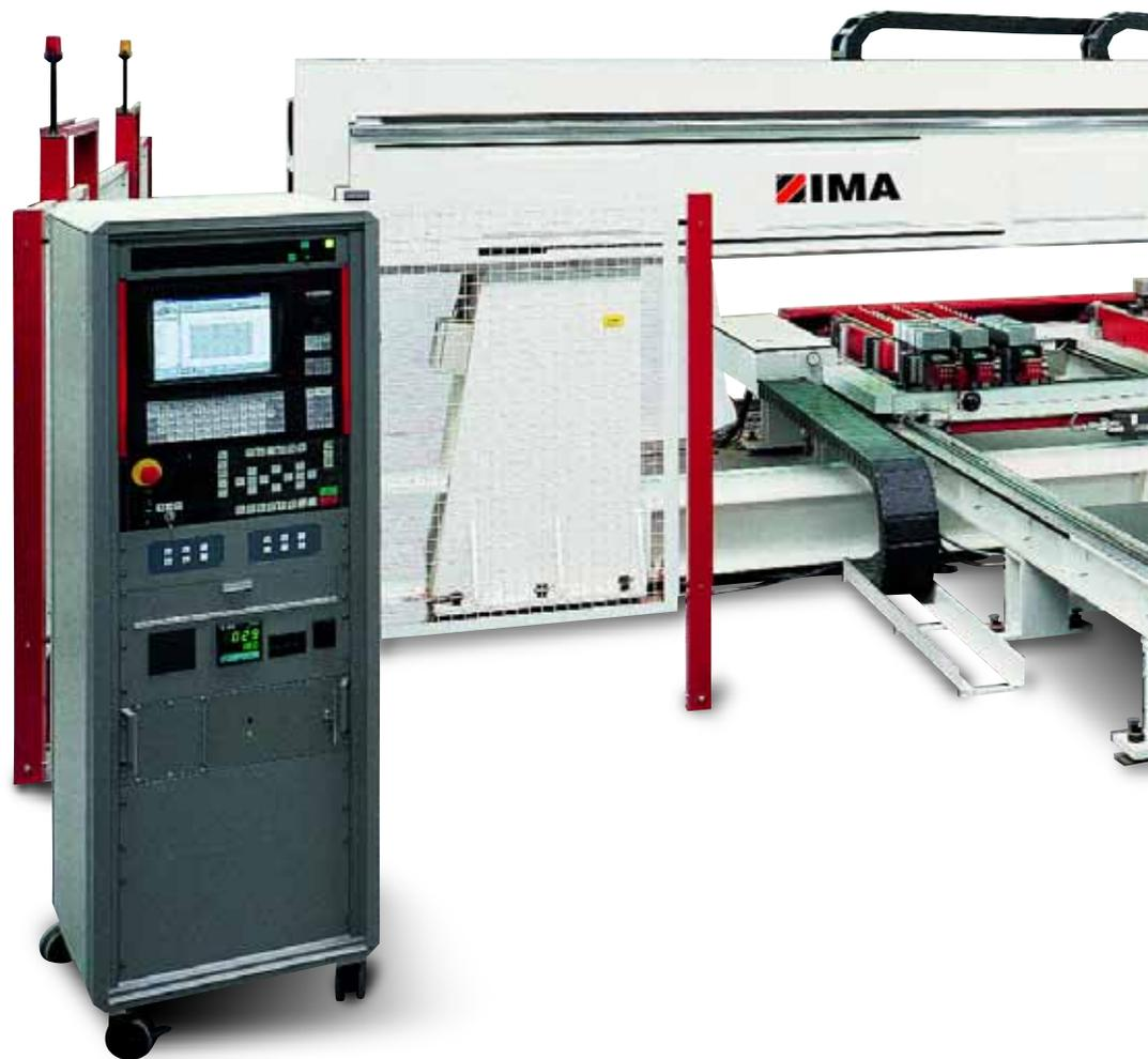
Eine mögliche Konfiguration: Doppeltisch mit Vakuumtraversen, geführte Sauger mit Indexpositionierung, Bearbeitungssupport in Doppelanordnung hinten und Verleimeinheit vorn. Durch die Vielzahl ihrer Optionen kann die BIMA 980 optimal an jede Bearbeitungsaufgabe angepaßt werden.
