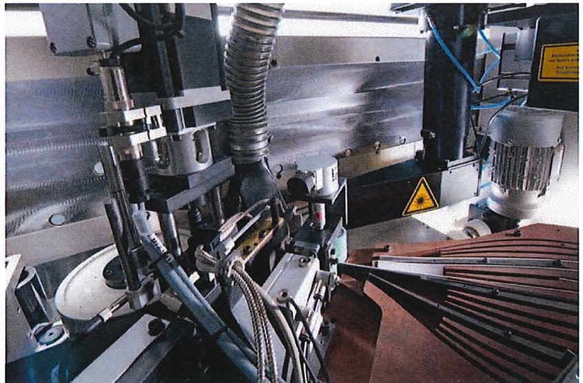
Das Herz des Laser-Edging-Verfahrens: Der punktgenaue Laserstrahl und die Anpressstation
