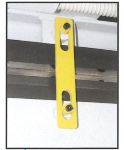
Chiavistello per bloccaggio piani in fase di manutenzione Verrou blocage plateau Dispositivo de bloqueo plato móvil en fase de mantenimiento
