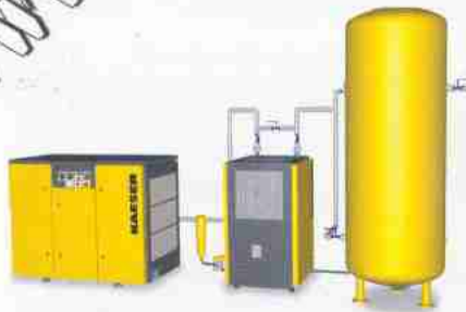
Aufstellungsvariante 2 Bei stark schwankendem Druckluftbedarf wird der SECOTEC®-Kältetrockner zwischen Kompressor, Zyklonabscheider und Druckluftbehälter geschaltet.
