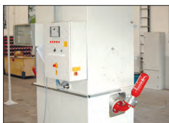
Explosionsunterdrückung durch automatische Löschmitteleinbringung
