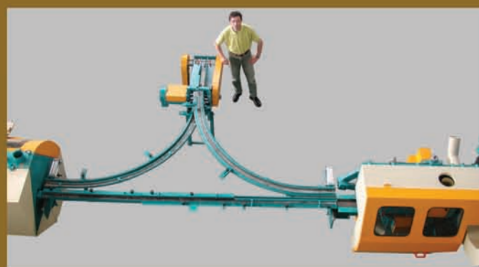
Okretna pruga za izradu ljevih ili desnih parketnih daščica Turning device for production of left or right parquet blocks
